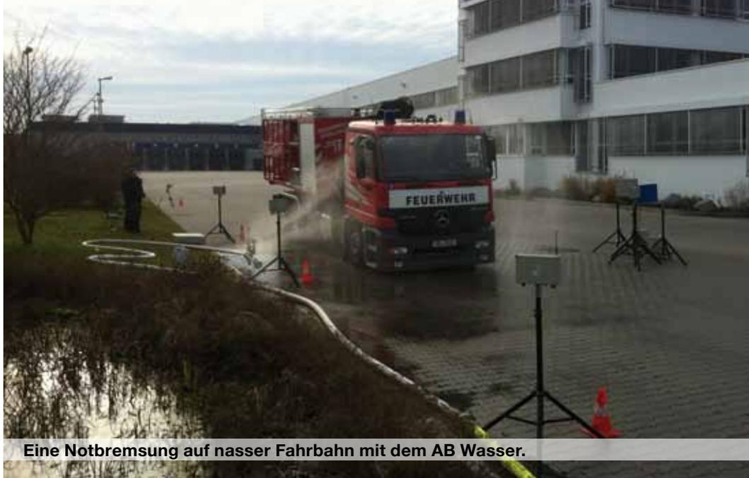
Eine Notbremsung auf nasser Fahrbahn mit dem AB Wasser.
